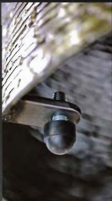
Oben: Einer von drei Verstellerfüßen im Inneren des Leuchters, die ihn standsicher machen
