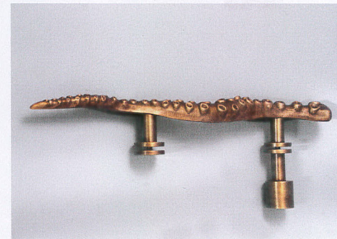
Tentakel-Türgriff für eine Dusche, angefertigt von Peter Schmitz. Am Rechner in 3D entwickelt, Modell (oben) in 3D gedruckt und dann in Bronze abgegossen
